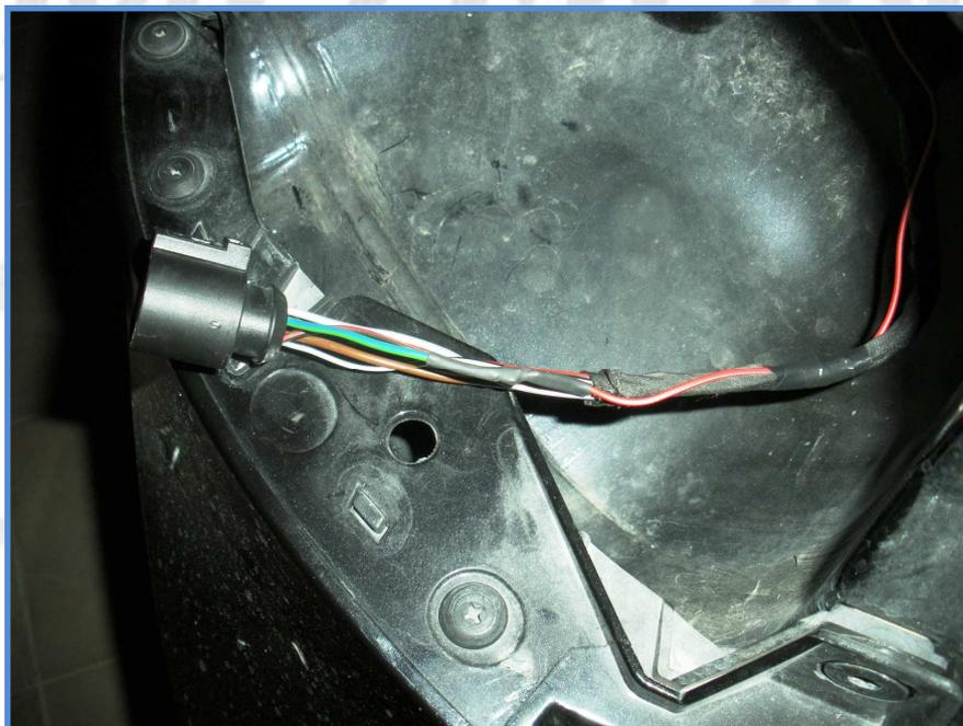
Collegare, ora, il filo nero dell'alimentazione della centralina alla carrozzeria dell'auto; l'asola che si trova vicino al passacavi della luce targa può fare al caso nostro: grattare con un giravite attorno all'asola (altrimenti non viene presa la massa) e avvitarci una vite facendo schiacciare l'estremità del filo nero dalla vite stessa sulla carrozzeria dell'auto.
